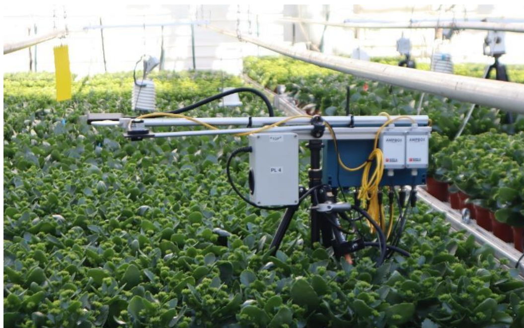
Figuur 29. FytaWatch opstelling in de proefkas. De netto straling-, PAR- en planttemperatuursensor hangen boven het gewas (aan het linker uiteinde van het apparaat). De luchttemperatuur, RV en CO 2 worden gemeten door de grijze box die aan het frame is gemonteerd.
