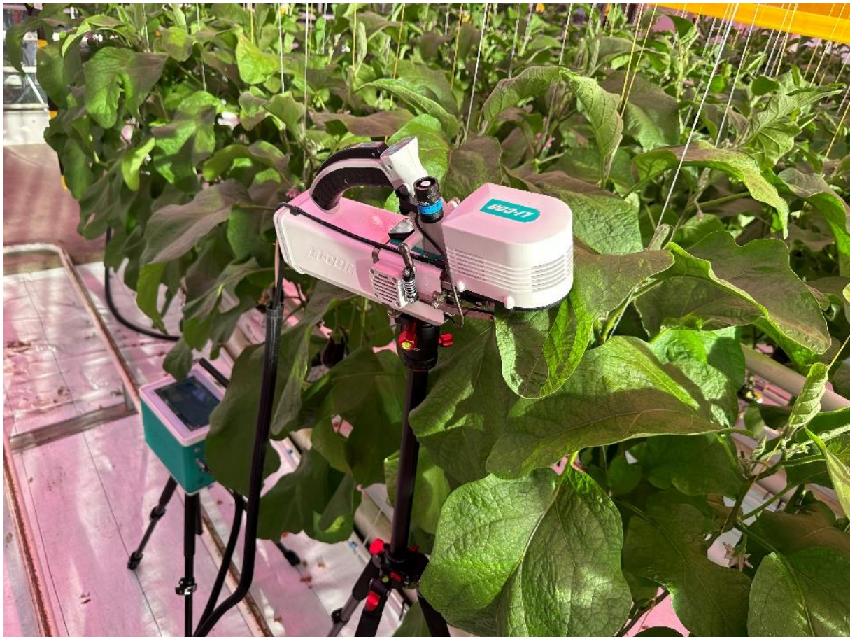
Figuur 3-1. De LI-6800 draagbare fotosynthesemeter in de auberginekas. In de meetcuve kunnen PAR, \text{CO}_2 , temperatuur en vocht worden gevarieerd. Er is gekozen om te meten bij 200 \mu\text{mol}/\text{m}^2/\text{s} PAR en een vast \text{CO}_2 -gehalte van 800 ppm en temperatuur en vocht met de kasomstandigheden mee te variëren over de dag heen.
