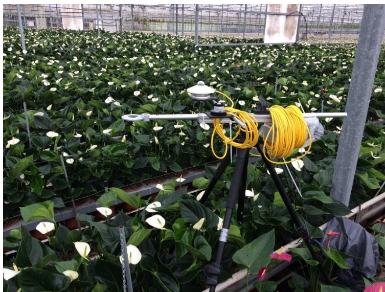
Foto 1. Meting van de netto straling, de zonnestraling en de PAR bij Evanty te Moerkapelle.
