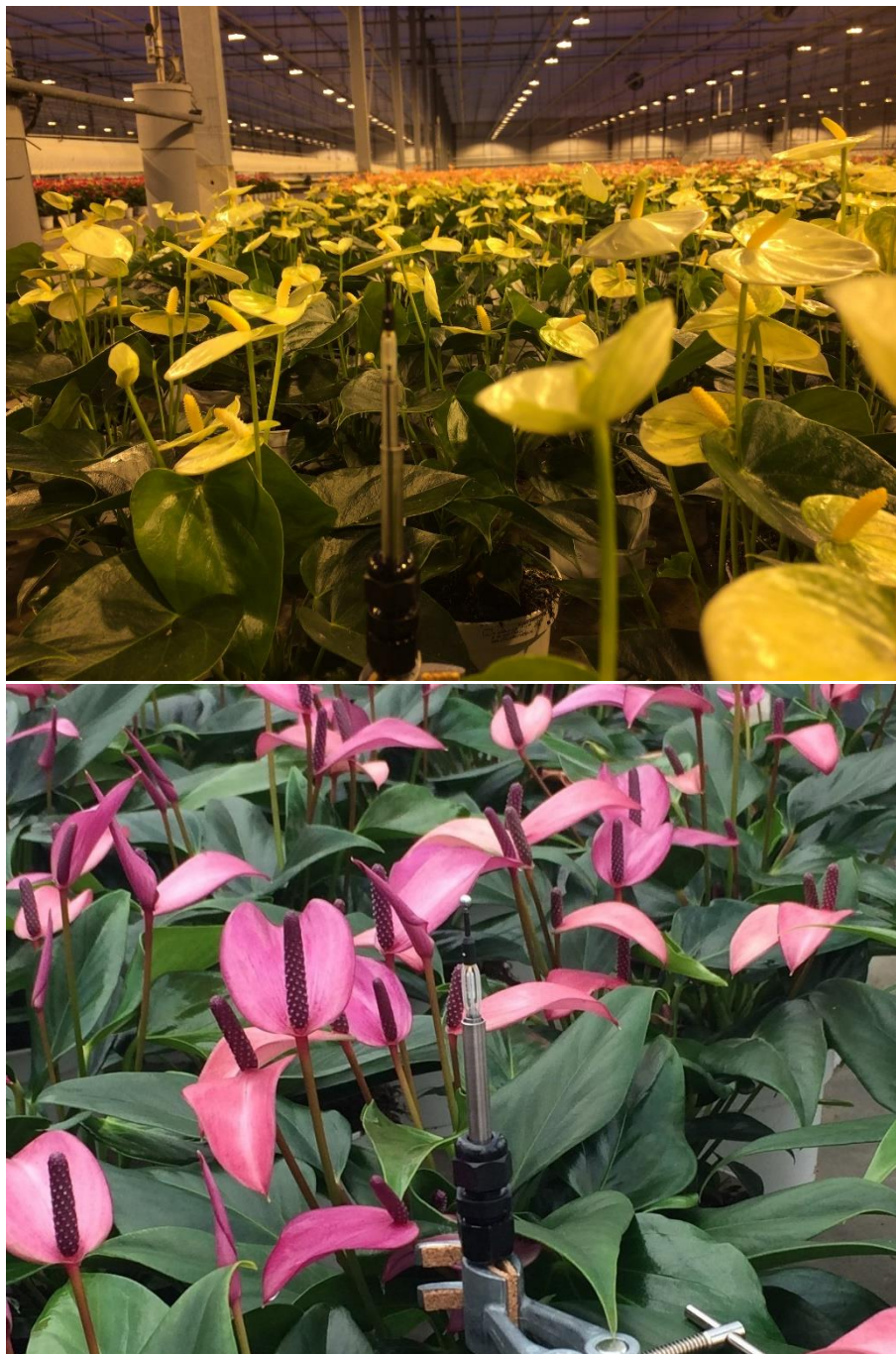
Foto 4. Gebruik van een omni-directionele luchtstroommeter om de luchtstroom op het niveau van top gewas te bepalen.
