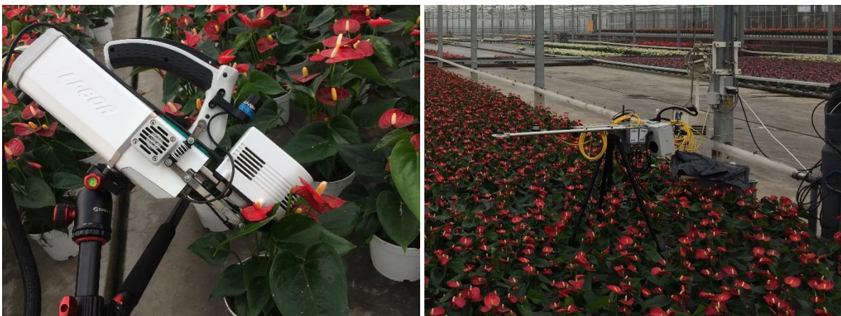
Foto 2. Metingen Gs en CO 2 -opname met een Li-6800 (links) en meetopstelling met een netto stralingsmeter bij Stolk Brothers (rechts).
