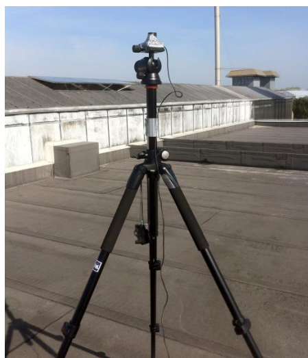
Foto 3. Meting van de hoeveelheid PAR buiten ter ijking van de Solarimeter van Tesselaar. De sensor stond op het platte dak van de koelcel van de locatie Alton 19 ter hoogte van de nok van de kas.
