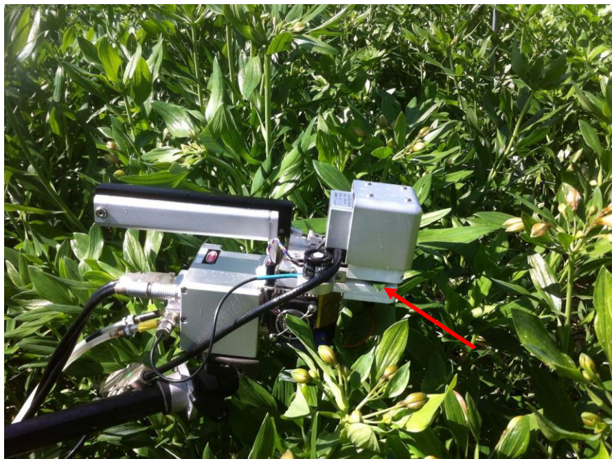
Foto 4. Meting van de fotosynthese met een draagbare fotosynthesemeter (LI-6400). In het apparaat kunnen PAR, CO 2 , temperatuur en vocht gevarieerd worden. Op deze manier wordt de fotosynthese-snelheid gemeten bij een bepaald niveau PAR en CO 2 aan een ingeklemd blad (rode pijl).
