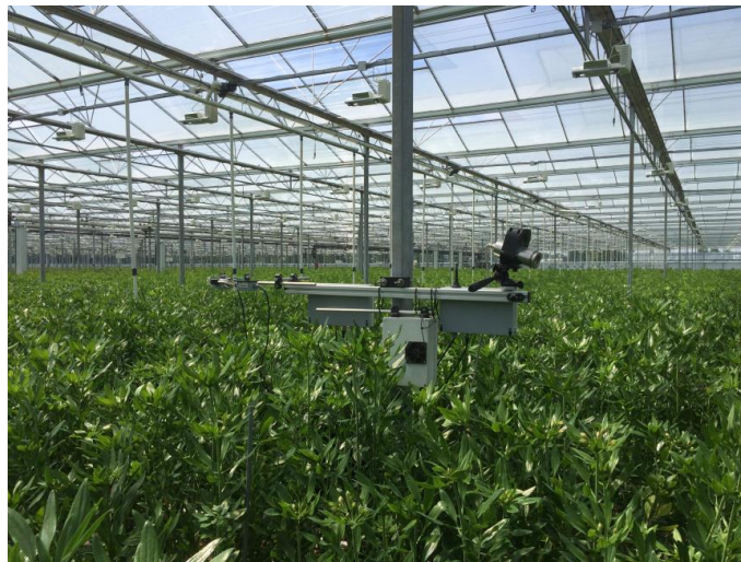
Foto 2. Growwatch voor de monitoring van temperatuur, CO 2 , RV en de planttemperatuur.
